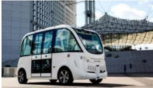
Der französische Hersteller Navya SAS wurde 2014 gegründet und stellte 2015 mit dem Kleinbus Arma das erste fahrerlose Serienfahrzeug vor. Der Shuttle bietet maximal Platz für 15 Personen und kann technisch bis zu 25 km/h schnell fahren. Die Batteriekapazität erlaubt dabei eine Betriebsdauer von bis zu 9 h, danach benötigt die Batterie einen 4- bis 8-stündigen Ladevorgang.<sup>62</sup> Die Kosten eines Shuttles betragen ca. 250.000 €, variieren jedoch nach individueller Konfiguration.
