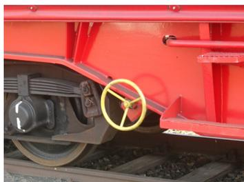
Abbildung 10: Bodenhandbremse an Güterwagen
