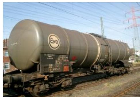
Abbildung 6: Mineralölkesselwagen
