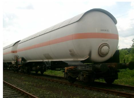
Abbildung 5: Druckgaskesselwagen
