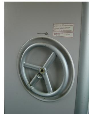
Abbildung 9: Handbremse in Reisezugwagen
